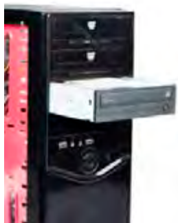
شکل ۵۰- قراردادن دیسک گردان نوری در کیس
