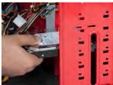
شکل ۴۸- محل نصب دیسک سخت
