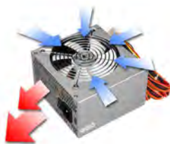
شکل ۲۳- جهت تهویه هوا در منبع تغذیه
