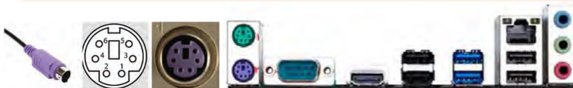
شکل ۸- درگاه‌های روی برد اصلی
