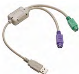
شکل ۱۰- مبدل درگاه PS/2 به USB
