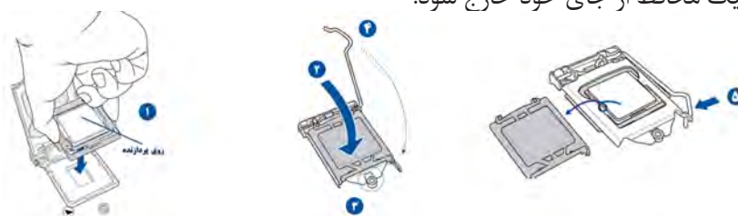
شکل ۳۵- مراحل قراردادن پردازنده در سوکت
