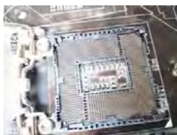
شکل ۳۳- سوکت پردازنده
