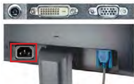
شکل ۴- محل اتصال کابل‌های صفحه نمایش
