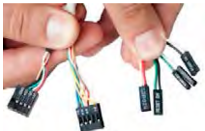
شکل ۴۴ - کانکتورهای پنل جلوی کیس
